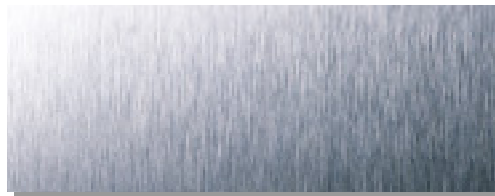
2K Het gladde en weerkaatsend oppervlak is uiterst geschikt voor de meeste architecturale toepassingen, vooral voor buitentoepassingen die een reëel gevaar voor atmosferische vuilafzetting inhouden. De afwerking wordt verkregen door het gebruik van fijnere schuurbanden of borstels, die fijne slijplijnen produceren met een maximale ruwheid van R_a = 0.5 micron.
